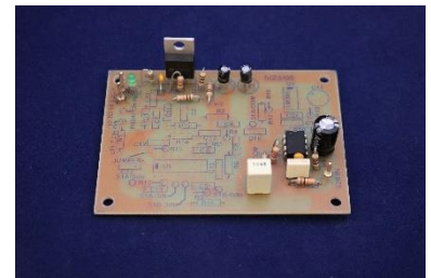
Figuur 5: Printplaatje met een gemonteerde vermogensversterker.
