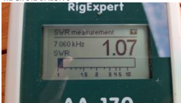
SWR 1 : 1 BALUN met een 40m dipool
