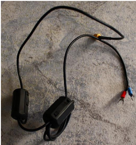
Figuur 5 RG-174 coax met de ferrietklemmetjes en vorkkabelschoentjes
