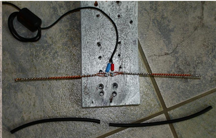
Figuur 4 70cm dipool met krimpkous
