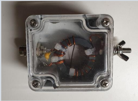
Figuur 1 Transformator voor 10-20-40 endfed antenne.
