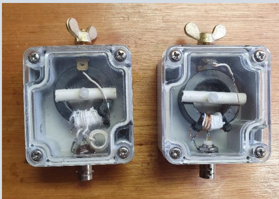
Figuur 10 Ingebouwde endfed transformatoren zonder en met compensatienetwerk.
